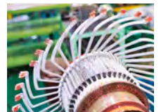
大修 (コイル巻替工事)
